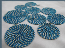
每2针绕线芯1圈 1/2 (最高转速：750)
