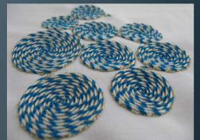
每4针绕线芯1圈 1/4 (最高转速：1,000)
